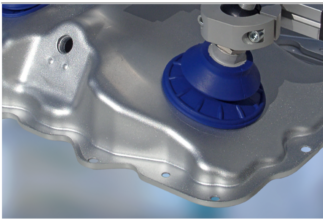
Ventosas de fuelle SAB durante la manipulación de piezas de carrocería de automóvil
